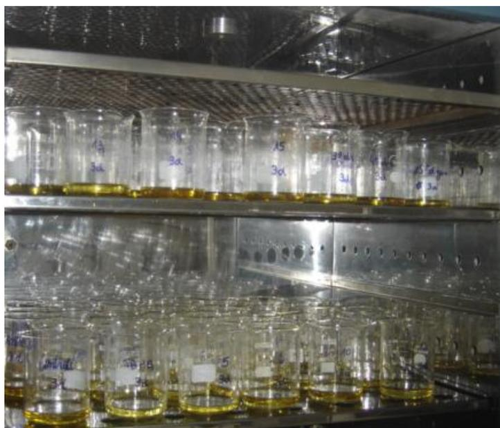
Figura 6 – Amostras de óleos vegetais durante o *Schaal Oven Test*.
